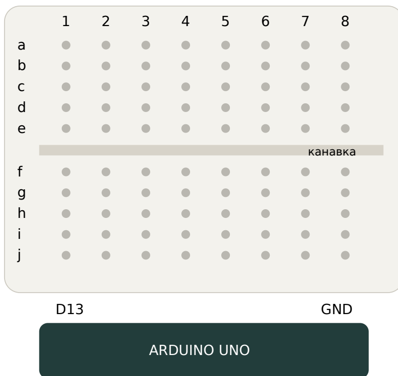
Фрагмент макетної плати · вигляд згори
